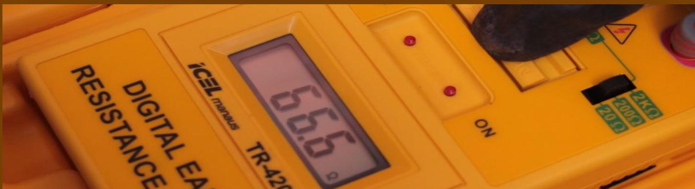
Segundo a própria ABNT NBR 15749, esta medição não pode ficar superior a 10% da medida de S (67,1ohm)
