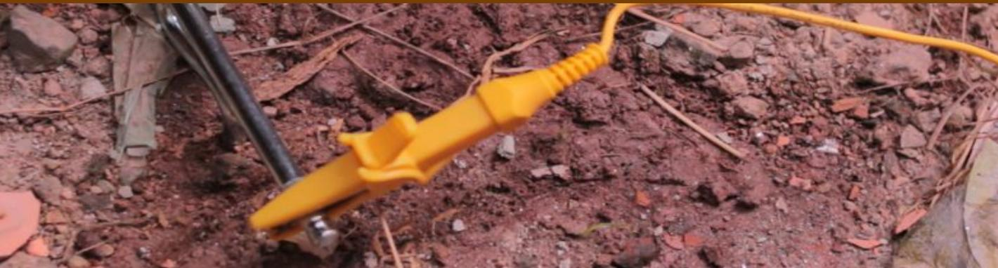
Realizando a medição podemos observar que o terrômetro mostra o valor de 66.6ohms
